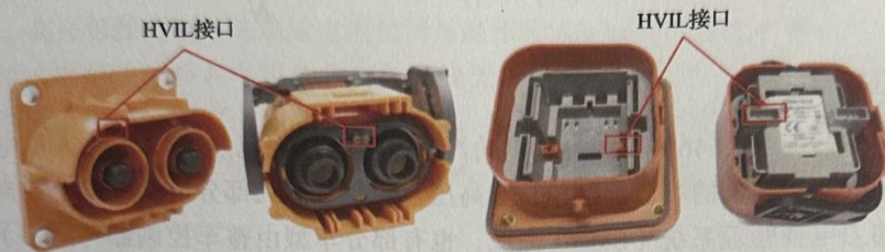
图 2-19 高压插接器与维修开关的高压互锁接口
