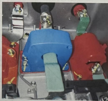
图 2-11 电动汽车霍尔电流传感器
