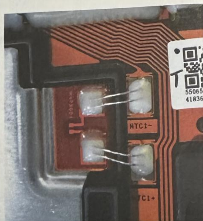
图 2-9 电池温度传感器 (NTC)
