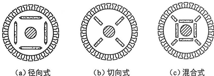
图3-5 内置式永磁同步电机的转子结构
